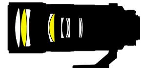
**Construction optique :** 10 lentilles en 6 groupes Distance minimale de mise au point : 1,45 m **Champ angulaire avec le format DX Nikon :** équivalent à celui d'un objectif 450 mm au format 24 x 36 **Diamètre du filetage pour filtres :** 77 mm **Parasoleil :** Intégré **Dimensions :** 90 x 222,5 mm **Poids :** 1 440 g (1 300 g sans collier de fixation sur pied)
