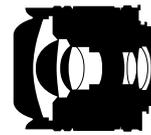
Construction optique : 8 lentilles en 5 groupes Distance minimale de mise au point : 0,25 m Champ angulaire avec le format DX Nikon : équivalent à celui d'un objectif 24 mm au format 24 x 36 **Filtres (fournis) :** L37C, A2, B2, O56 **Parasoleil :** intégré **Dimensions :** 63 x 57 mm **Poids :** 290 g
