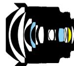
Construction optique : 14 lentilles en 12 groupes Distance minimale de mise au point : 0,2 m Champ angulaire avec le format DX Nikon : équivalent à celui d'un objectif 21 mm au format 24 x 36 **Diamètre du filetage pour filtres :** fixation à l'arrière de l'objectif 27 mm **Parasoleil :** intégré **Dimensions :** 87 x 86,5 mm **Poids :** 670 g
