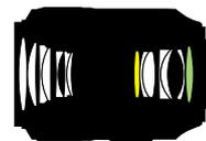
Construction optique: 14 lentilles en 12 groupes Distance minimale de mise au point: 0,314 m
