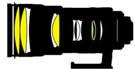
**Construction optique :** 11 lentilles en 8 groupes Distance minimale de mise au point : 2,3 m (2,2 m en mode MF) **Champ angulaire avec le format DX Nikon :** équivalent à celui d'un objectif 450 mm au format 24 x 36 **Diamètre du filetage pour filtres :** 52 mm **Parasoleil :** HK-30 (fourni) **Dimensions :** 124 x 267,5 mm (environ) **Poids :** 2 870 g (environ)
