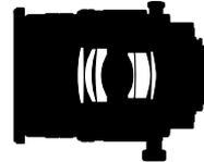
Construction optique : 6 lentilles en 5 groupes Distance minimale de mise au point : 0,39 m Champ angulaire avec le format DX Nikon : équivalent à celui d'un objectif 127,5 mm au format 24 x 36
